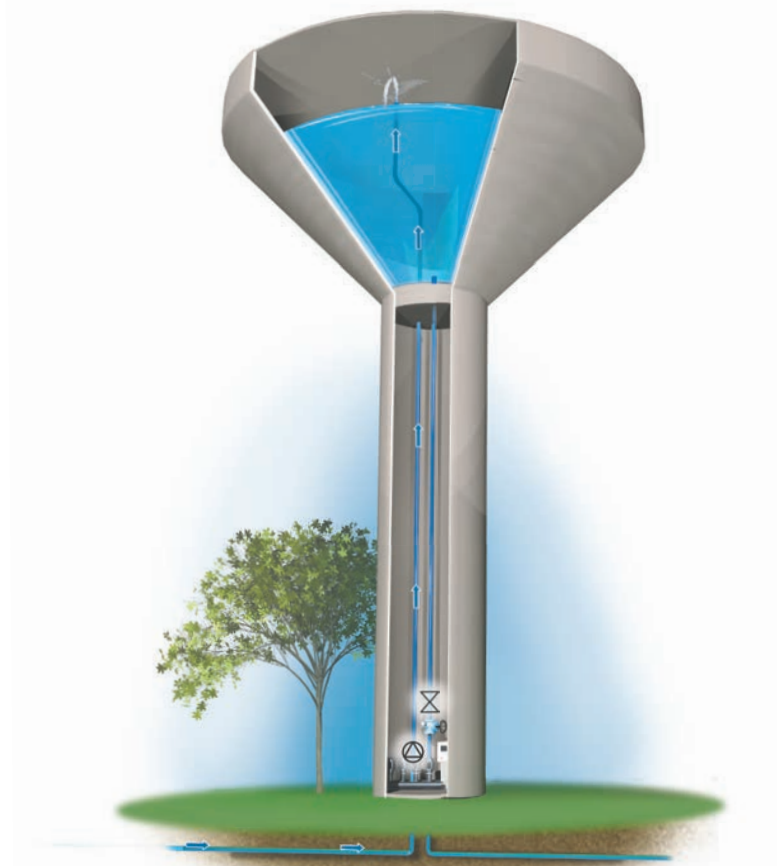
Водонапорная башня с установкой повышения давления и регулирующего клапана.
