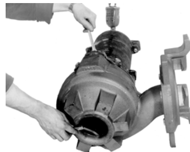
Fig. 14 Regolazione della luce della girante
