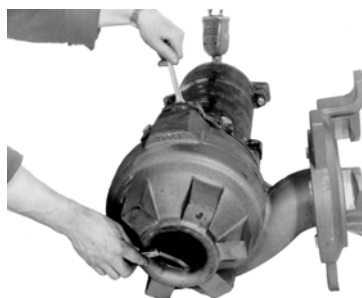
Fig. 14 Mesure de la tolérance de la roue
