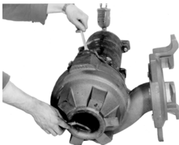
Abb. 14 Messung des Dichtspaltes
