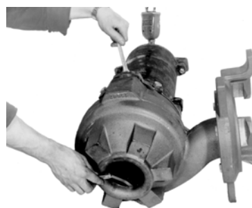
Fig. 14 Medición de la distancia entre impulsor y voluta
