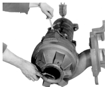
Fig. 14 Mätning av pumphjulsspalt
