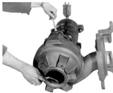
Σχ. 14 Μέτρηση διακένου πτερωτής
