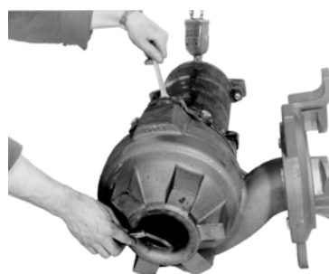
Slika 14 Mjerenje zazora rotora
