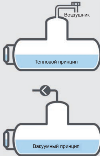
Рис. 9: Принципы работы оборудования.
