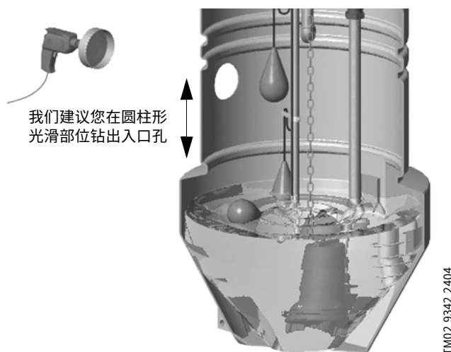
图 21 钻入口孔, \varnothing 400-1000
